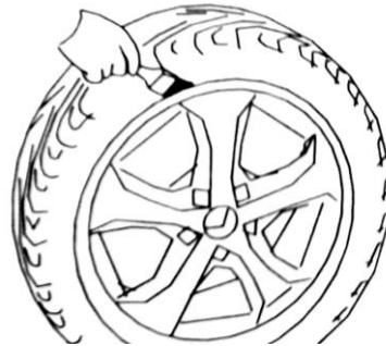
Рисунок 4.2 – Нанесение смазки на борт шины
