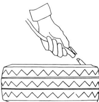
Рисунок 5.1 – Подключение воздушной магистрали
